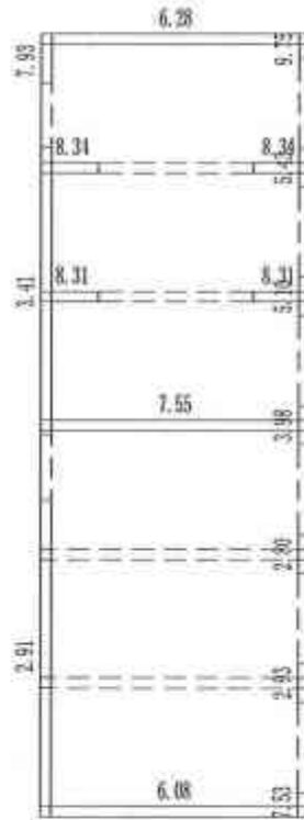
6-7/A-B 轴区域一层墙体受压承载力计算结果图
